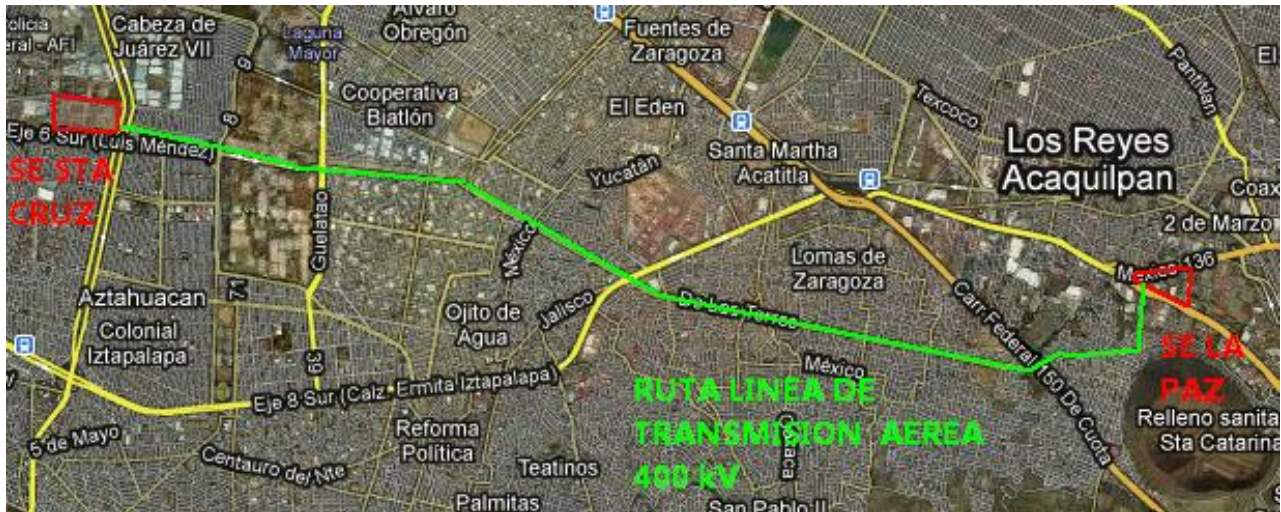
Figura 2.6 Ruta de la línea aérea 400 kV entre las subestaciones Santa Cruz y La Paz. Longitud aproximada: 11 Kilómetros.
