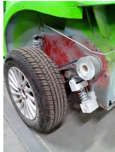
Imágenes 2.7. Transmisión de potencia: motores eléctricos, sistema de poleas y banda a tensión mediante un amortiguador.
