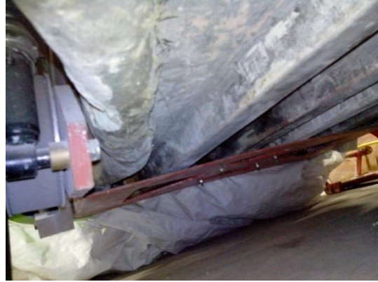
Imágenes 2.8. Largueros de PTR y elemento estructural en “C” para suspensión delantera (en rojo).
