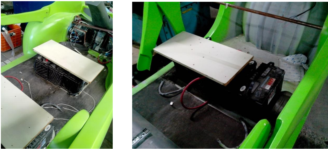
Imágenes 2.10. Distribución de baterías en el vehículo.
