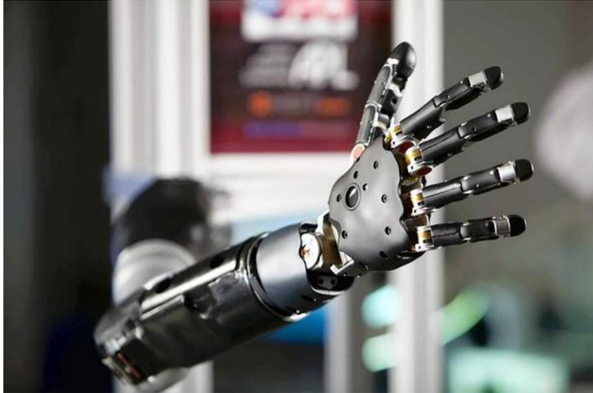
**Figura 2.5** Modular Prosthetic Limb (MPL) fabricado por DARPA.
