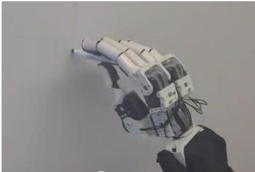
**Figura 3.3** Prototipo de prótesis robótica de mano (Versión 2).
