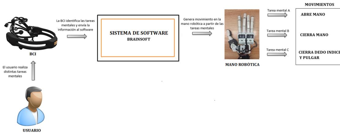
**Figura 4.6** Proceso de identificación y selección de tareas mentales para la generación de movimientos en la mano robótica.
