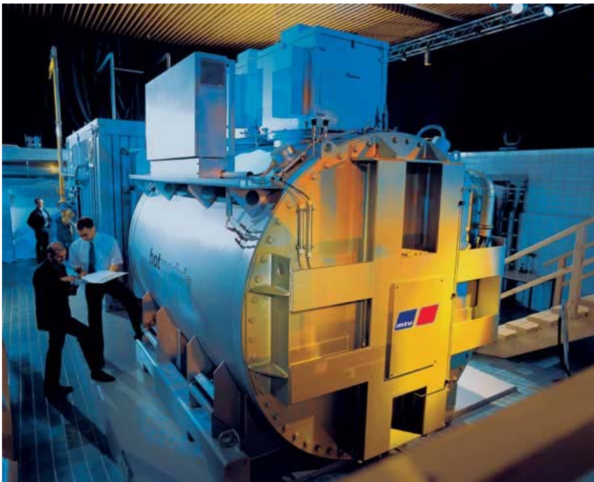
Fig. 2.8 Celda de combustible MTU Friedrichshafen MCFC [10].
