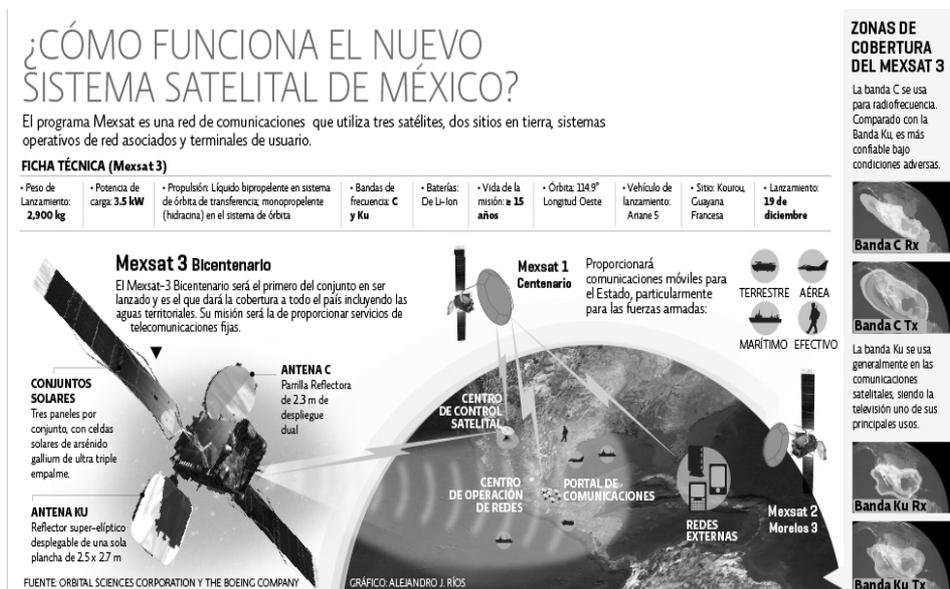
**Figura 1.1 Estructura del sistema satelital Mexsat<sup>1</sup>**
