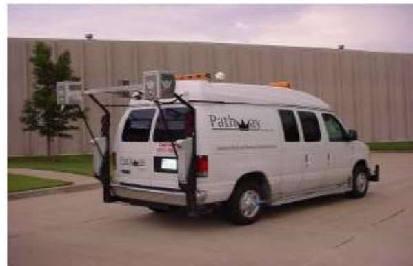
Imagen 3.5 Método automatizado (equipo PathRunner XP).
