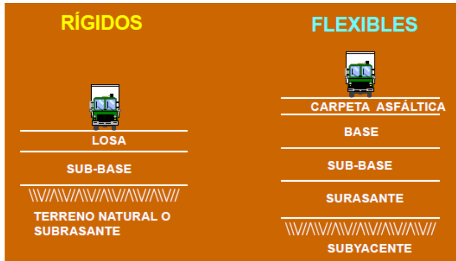
Figura 2.9 Estructuras tipo de los pavimentos.
