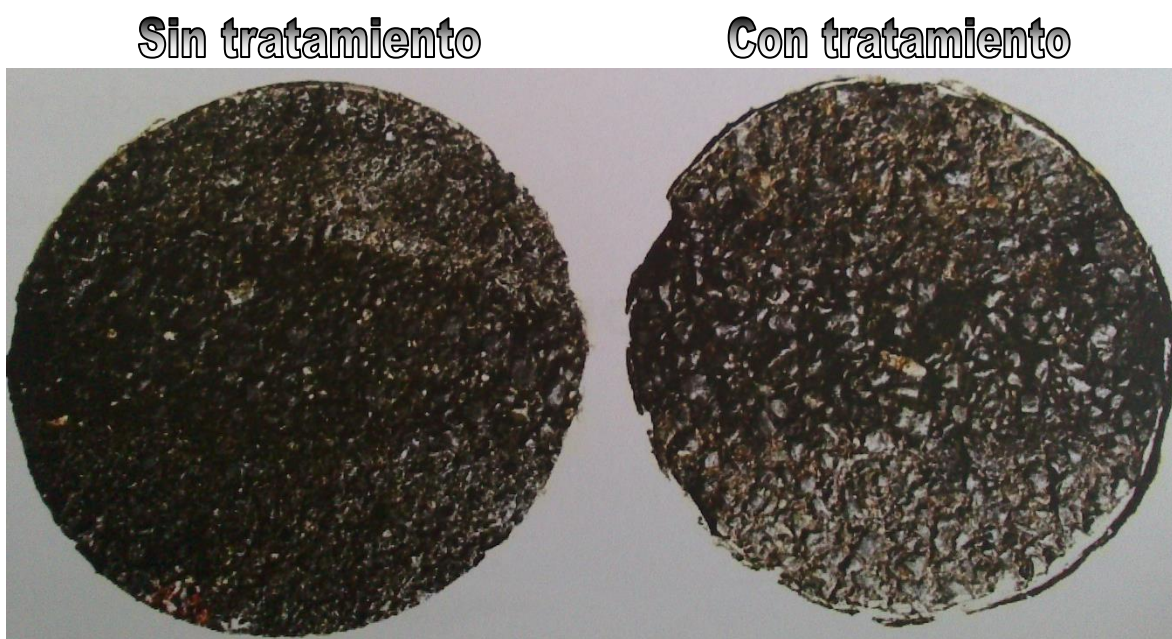
Figura 6.2 Prueba de desgaste en dos corazones de diferentes pavimentos con y sin tratamiento.
