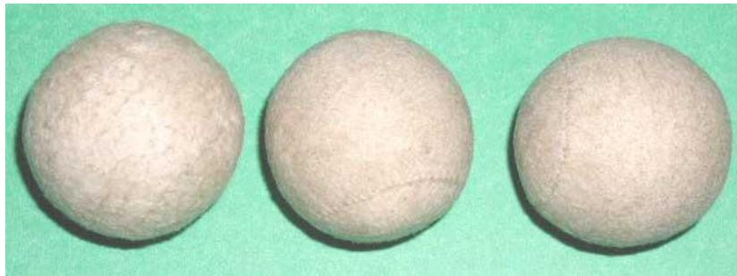
Figura 8. Pelotas de celuloide cubiertas de tela [10].
