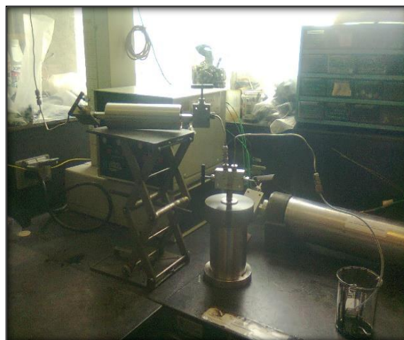
Figura A.9.- Proceso de saturación de aceite de las muestras de roca
