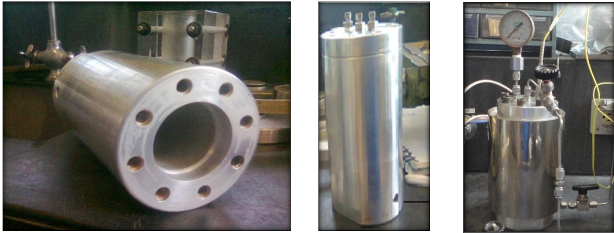
Figura A.3.- Generador de vapor.
