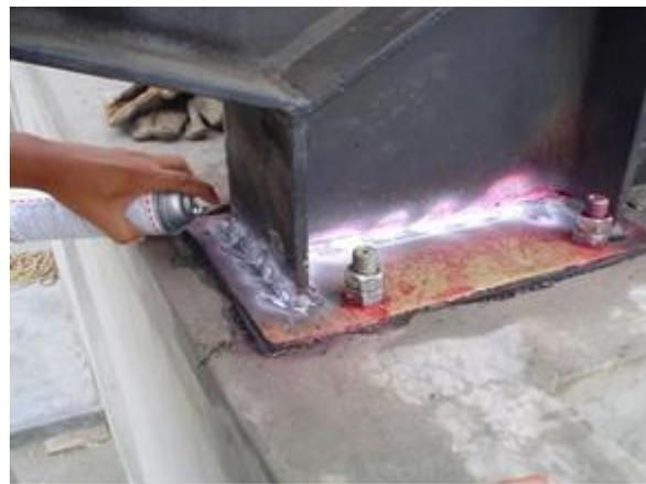
FIG. 43 .- PRUEBA DE LÍQUIDOS PENETRANTES
