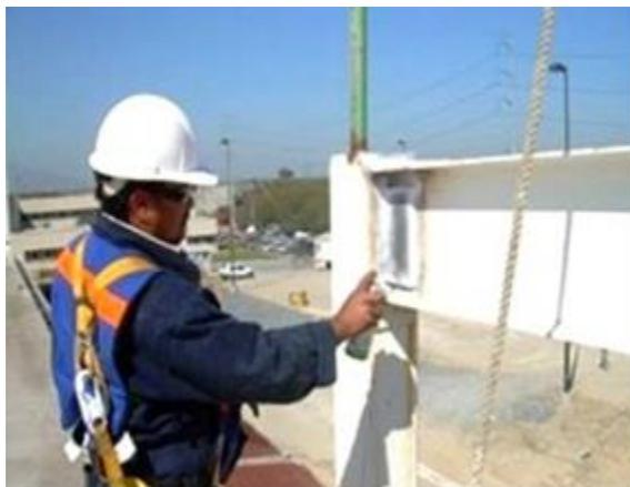
FIG. 42 .- PRUEBAS A LA SOLDADURA
