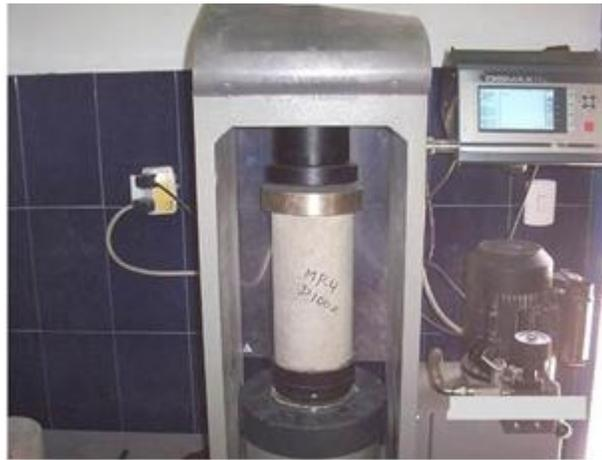
FIG. 15 .- PRUEBA DE RESISTENCIA A LA COMPRESIÓN DEL CONCRETO
