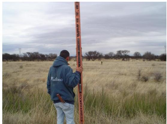
El control terrestre para proyecto de carreteras tiene características especiales, que obedecen a la metodología establecida y su relación con la construcción, su uso es múltiple, sirve para "dimensionar" el modelo estereoscópico, en primera instancia, para replantear el eje del proyecto en campo, para conservar sus dimensiones durante la construcción y comprobaciones posteriores a ella.
