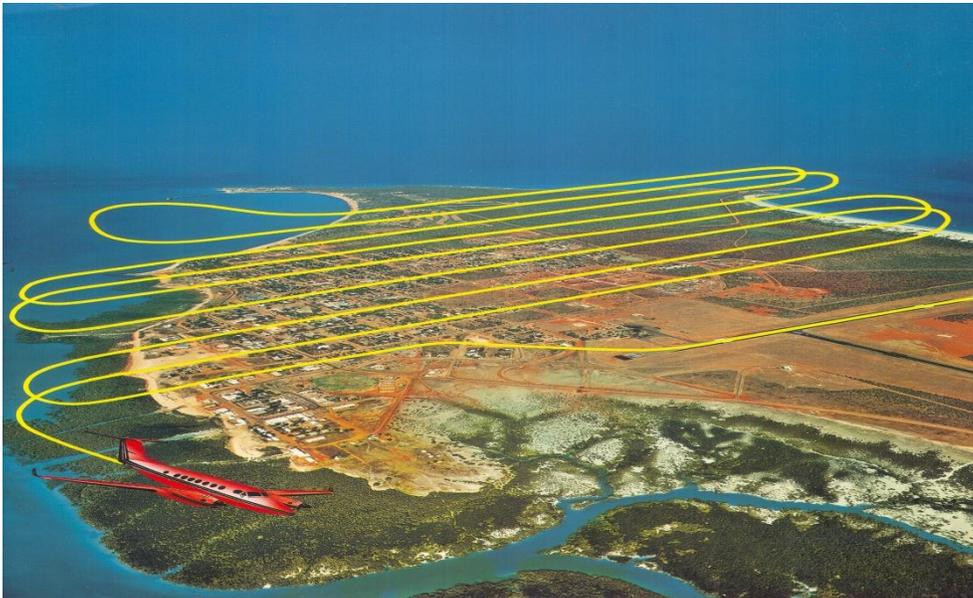
Para la toma de fotografías aéreas , se utilizan cámaras métricas de eje vertical, con lente gran angular con distorsión máxima de 0.01 mm y distancia focal aproximadamente 152 mm., con formato de 23 x 23 cm ., tipo de objetivo lamgon PL 4.5/150 ., máximo ángulo de la imagen 92 grados., escalas del
