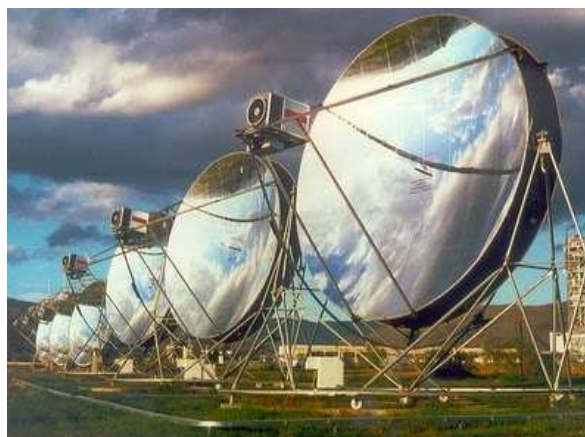
FIGURA 2.13 Concentrador dinámico de paraboloides de revolución
