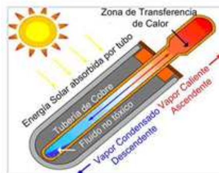
FIGURA 2.6 Funcionamiento de colector solar de tubos de vacío con tecnología Heat Pipe
