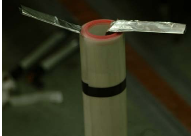
Figura 3.12 Placas del capacitor cuidadosamente enrolladas. Se pueden apreciar los contactos que también son de aluminio.
