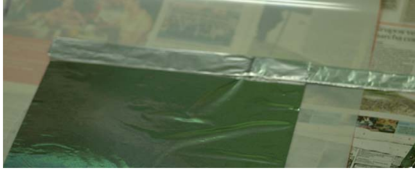
Figura 3.11 Foto donde se aprecia el extremo de una placa de aluminio enrollado para formar uno de los contactos del capacitor.
