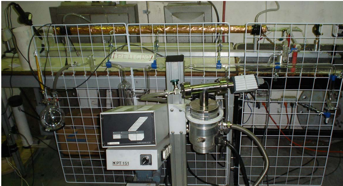
Figura 4.10 Láser de xenón construido en México. Se puede apreciar el tubo de descarga, la bomba turbo-molecular, el sistema de vacío, los espejos que forman la cavidad resonante, y el láser He-Ne usado para la alineación de la cavidad.
