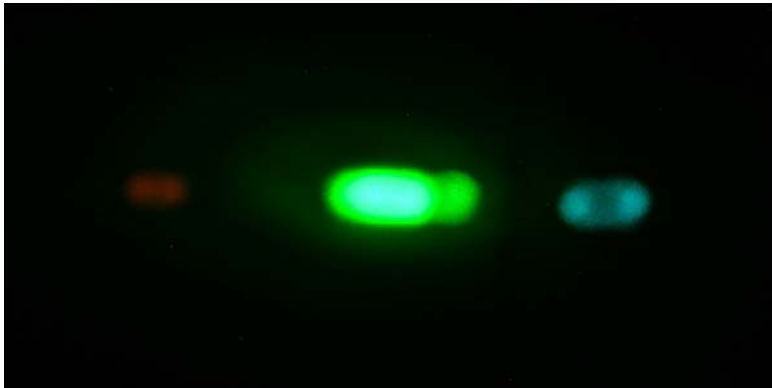
Figura 5.8. Transiciones obtenidas con el láser construido en México con una tensión de 14 KV y una presión de 30 mTorr. A diferencia de la figura anterior, aquí aparece una nueva transición (azul) la cual corresponde a \lambda = 495.4 \text{ nm}
