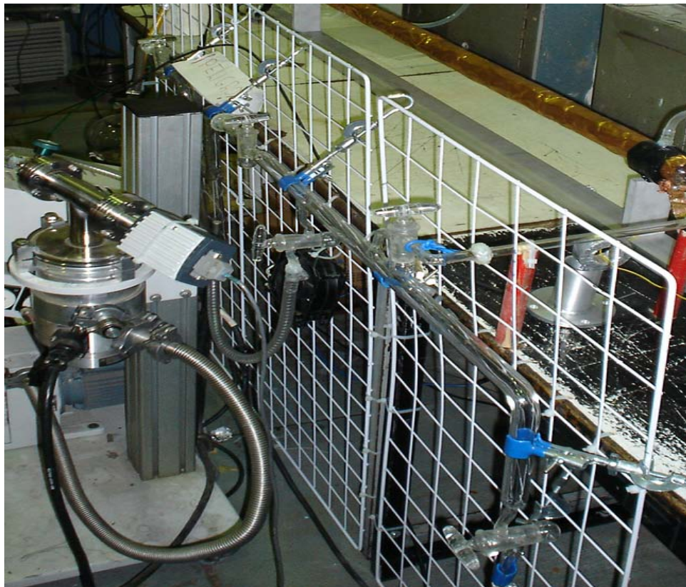
Figura 4.6 Sistema de vacío del láser. También se puede apreciar la bomba turbo molecular.
