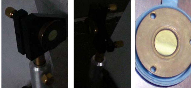
Figura 4.1 Espejos de la cavidad láser donde se pueden apreciar las monturas con los tornillos para facilitar su alineación.
