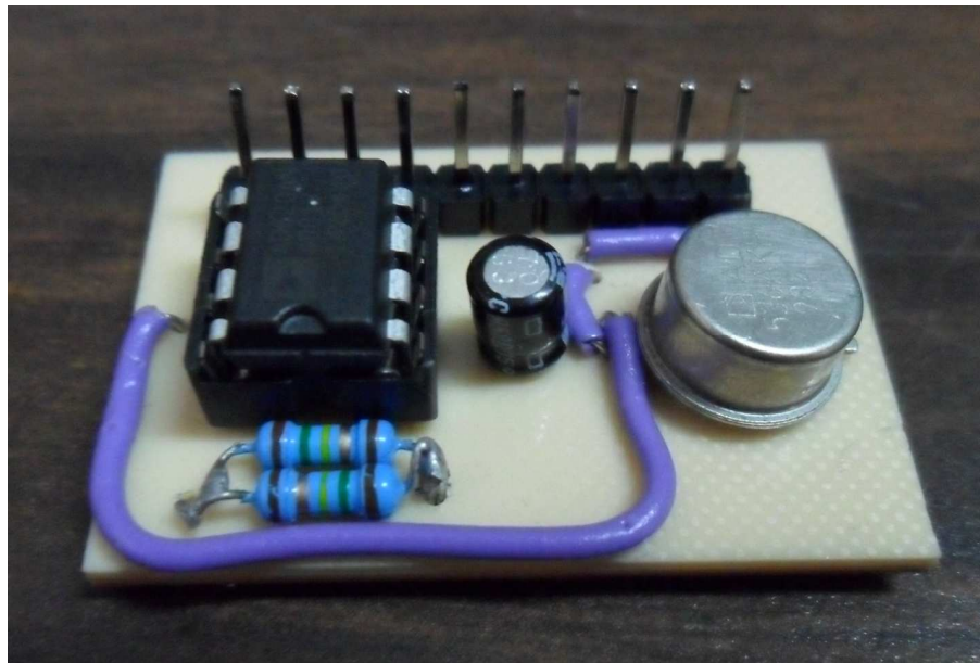
Figura 5.14 Vista superior de la PCB con sus componentes montados.
