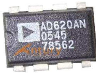
Figura 3.5 Amplificador operacional de instrumentación. [23]
