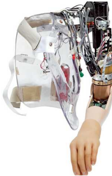
Figura 1.7 Prótesis de miembro superior con lectura de señales mioeléctricas por re-inervación en el pecho. [13]
