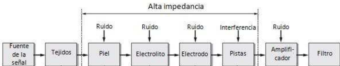
Figura 1.10 Diagrama de afectaciones a la lectura de una señal mioeléctrica. [16]
