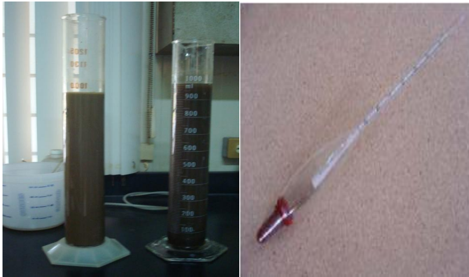
Figura 8. Cilindro de sedimentación con sedimento e hidrómetro.
