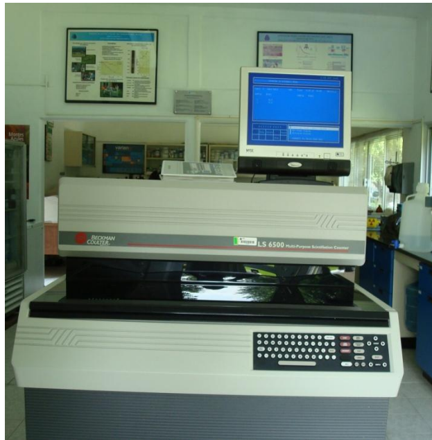
Figura 9. Contador de centelleo líquido utilizado para determinar la distribución de Cd en el sistema sólido-líquido.
