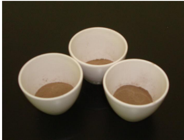
Figura 7. Crisoles con sedimento de la presa Colimilla para determinar materia orgánica.
