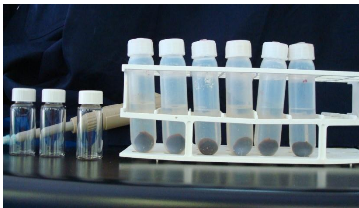
Figura 11. Separación de las fases después de la centrifugación y viales de conteo utilizados en contador de centelleo líquido.
