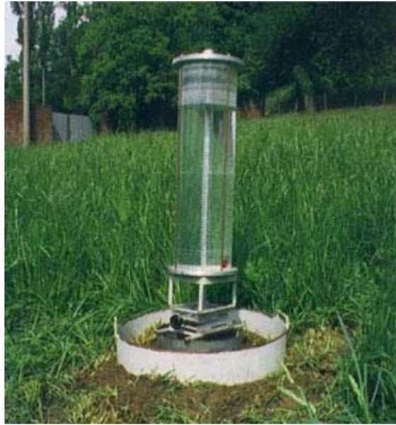
**Ilustración 55.** Infiltrómetro de carga constante
