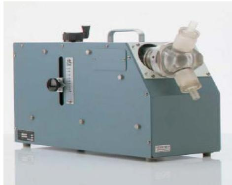
**Figura 1.16** Bomba pulsátil modelo 1423 para estudios hemodinámicos, Serie 1400 Harvard Apparatus [5].
