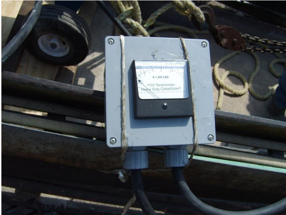
Figura III.40 Medidor de fuerza constante
