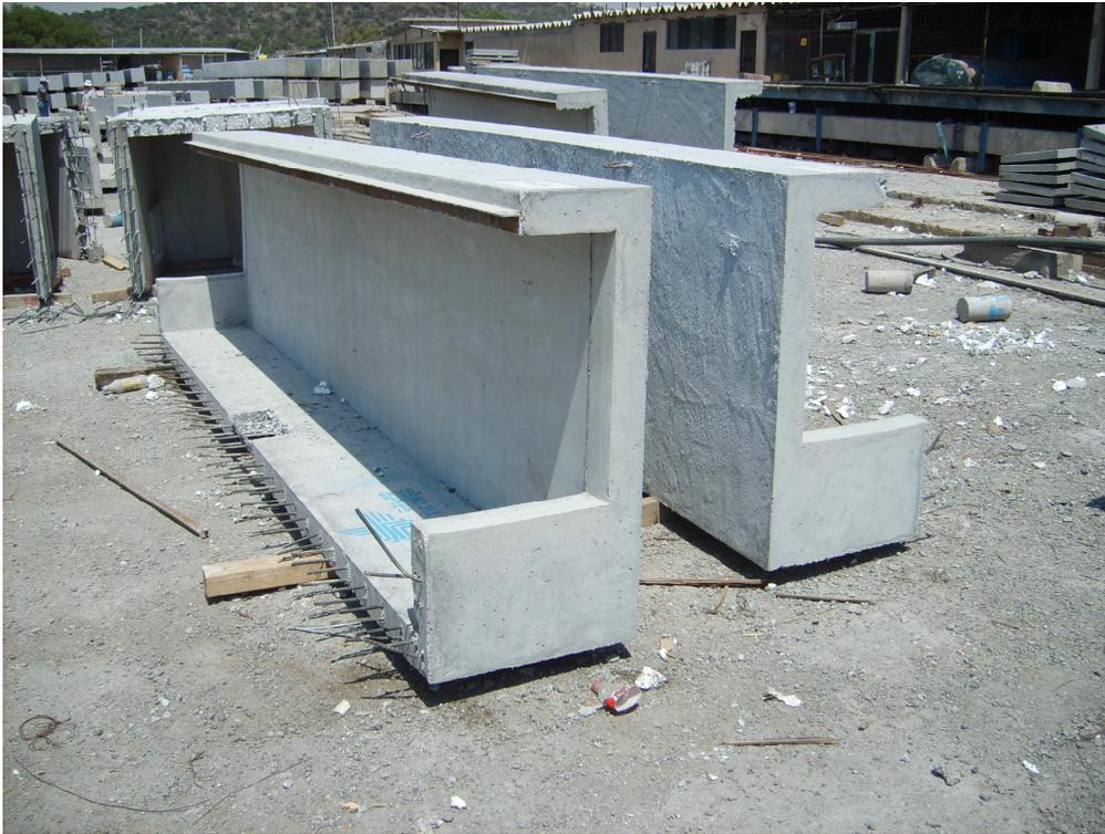
Figura III.18 Patios de fabricación, prefabricados tipo registro.
