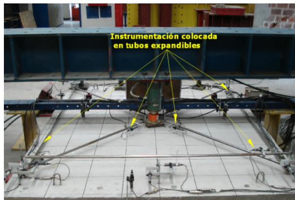
Figura 1.8 Fijación de transductores de 25 mm en tubos expandibles en el perímetro y diagonales del modelo de ensaye
