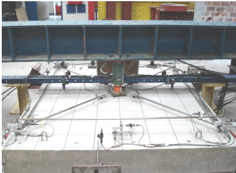
Figura 1.17 Vista posterior de un modelo, donde se observa la fijación del dispositivo de carga vertical a la viga de acero
