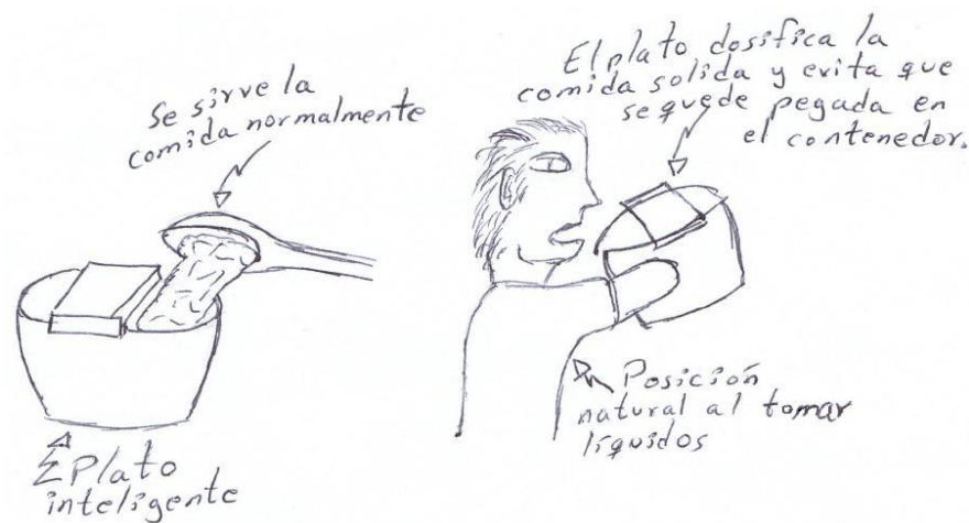
Figura 3.5 Boceto del funcionamiento del plato inteligente.
