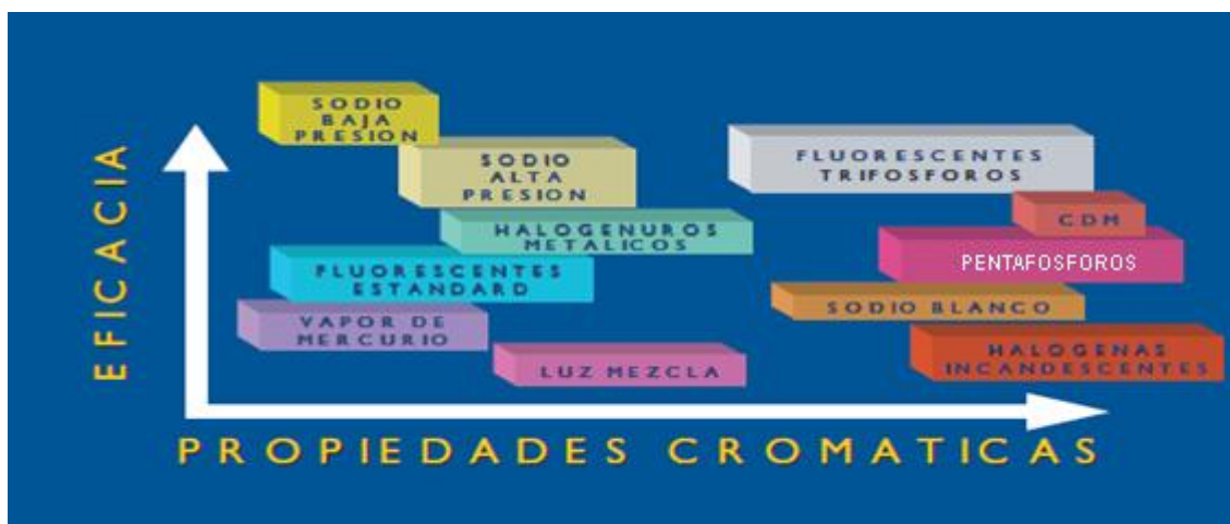
Figura 20. Propiedades cromáticas vs Eficacia en diferentes tipos de lámparas.
