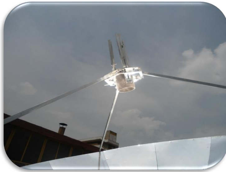
Imagen 3.3. Prueba inicial con receptor cilíndrico.
