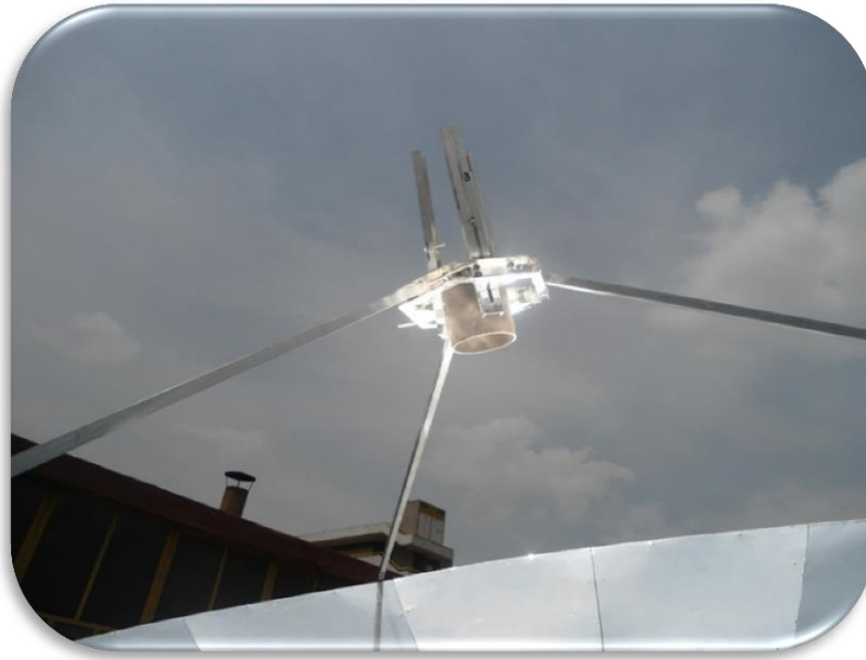
Imagen 3.3 Prueba inicial con receptor cilíndrico
