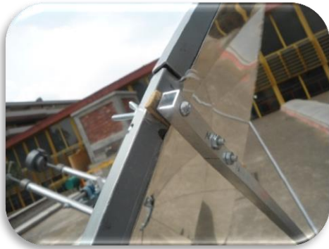
Imagen 2.17. Brazo para fijar el receptor al concentrador
