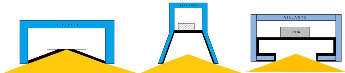
Imagen 4.2. Propuestas de receptor para el sistema de concentración en vistas seccionadas 2D (Propuesta 1 en la izquierda y propuesta 2 en medio y Propuesta 3 a la derecha)
