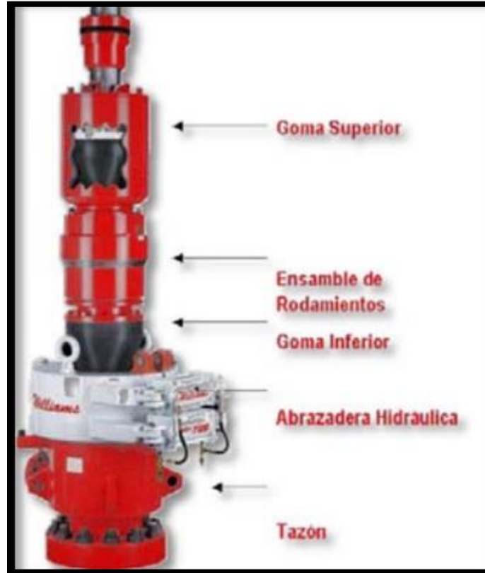
Figura 5.10. Cabeza rotatoria para contener la presión del pozo durante una operación de PBB (Tomada de López, 2011).
