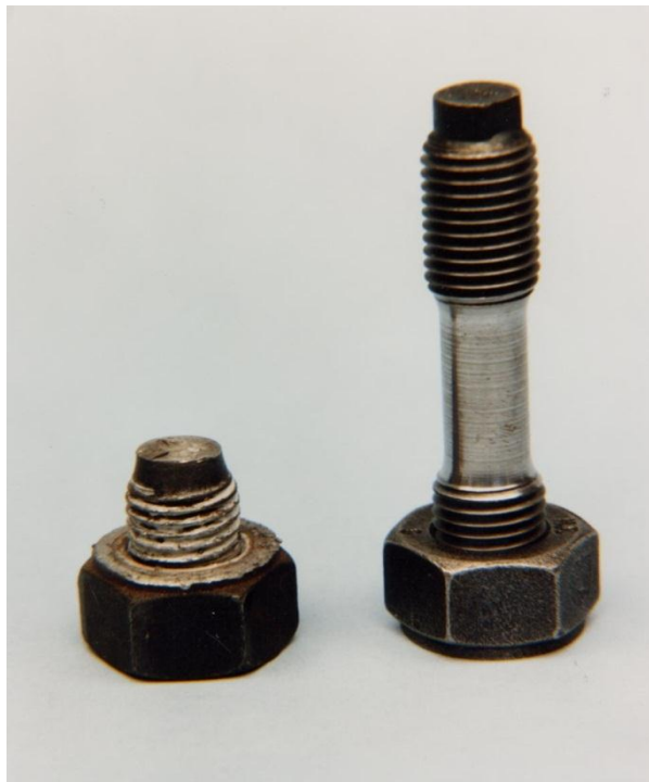
Fig. 4.4. Fractura de una válvula industrial por aferramiento. Fuente presentada por el cliente.
