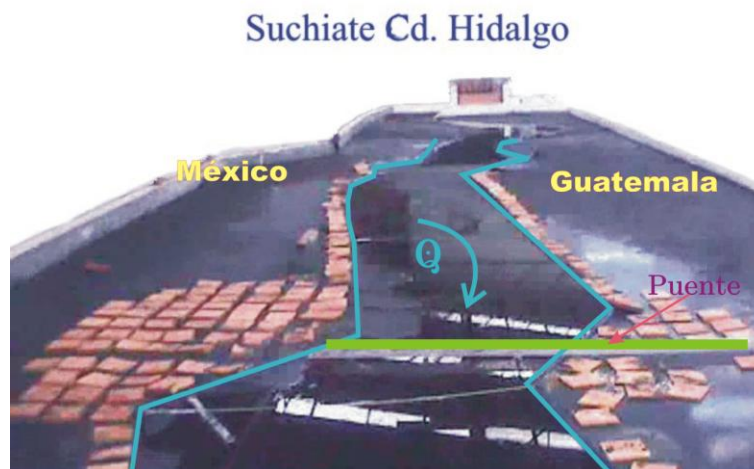
Fig. 3.4 Pruebas realizadas con gastos de distintas magnitudes para entender mejor el fenómeno, vista aguas debajo de Ciudad Hidalgo.
