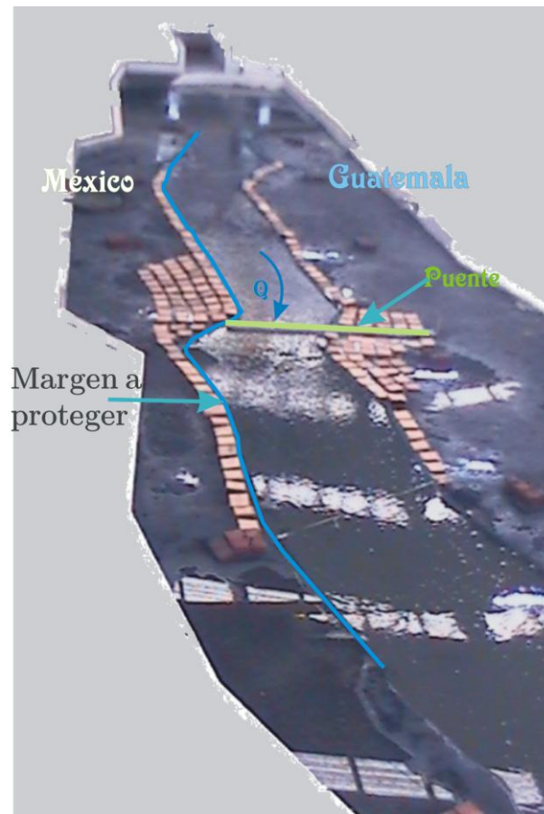
Fig. 3.3 Modelo del río Suchiate en el tramo de Ciudad Hidalgo. El principal objetivo de estudio era la protección de márgenes.
