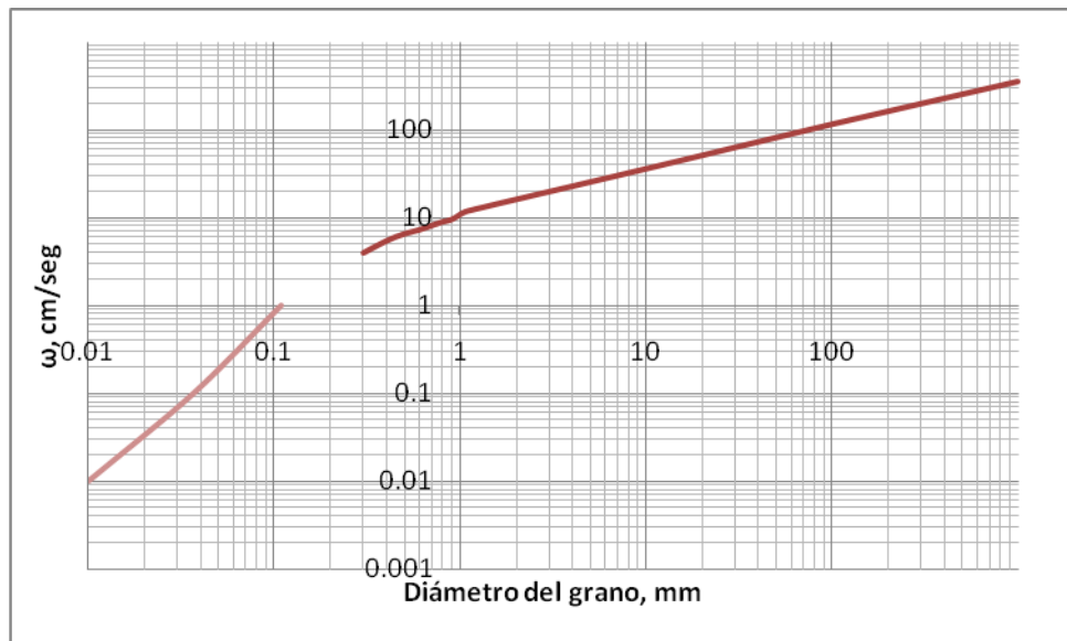
Fig. 4.7 Velocidad de caída o sedimentación ( \omega ), para diferentes tamaños de granos de cuarzo, según Rubey.
