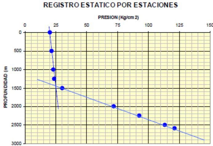
Figura 3.23: Comportamiento de la presión respecto a la profundidad para aceites.<sup>8</sup>
