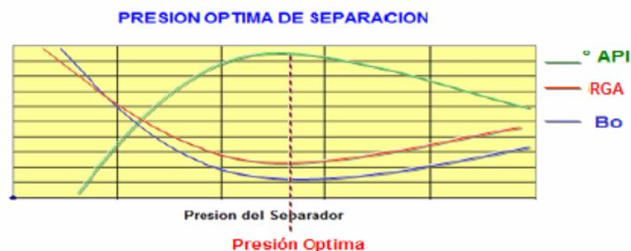
Figura 4.9: Determinación de la presión óptima de separación.
