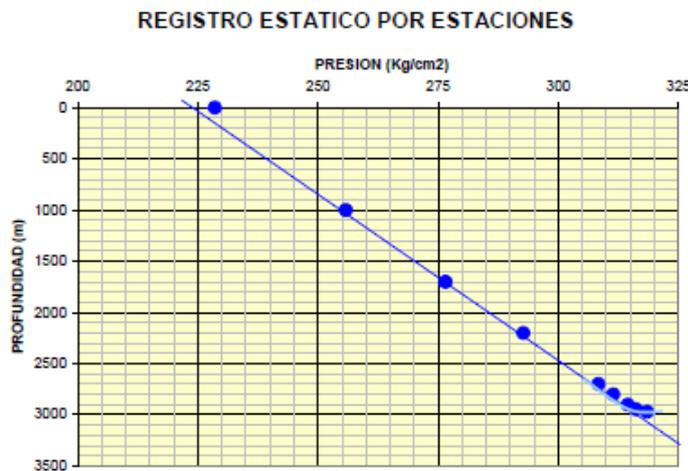
Figura 3.24: Comportamiento de la presión con respecto a la profundidad para gas y condensado.<sup>8</sup>
