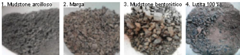
Figura 5.2: Muestras arcillosas antes de ser trituradas y tamizadas.
