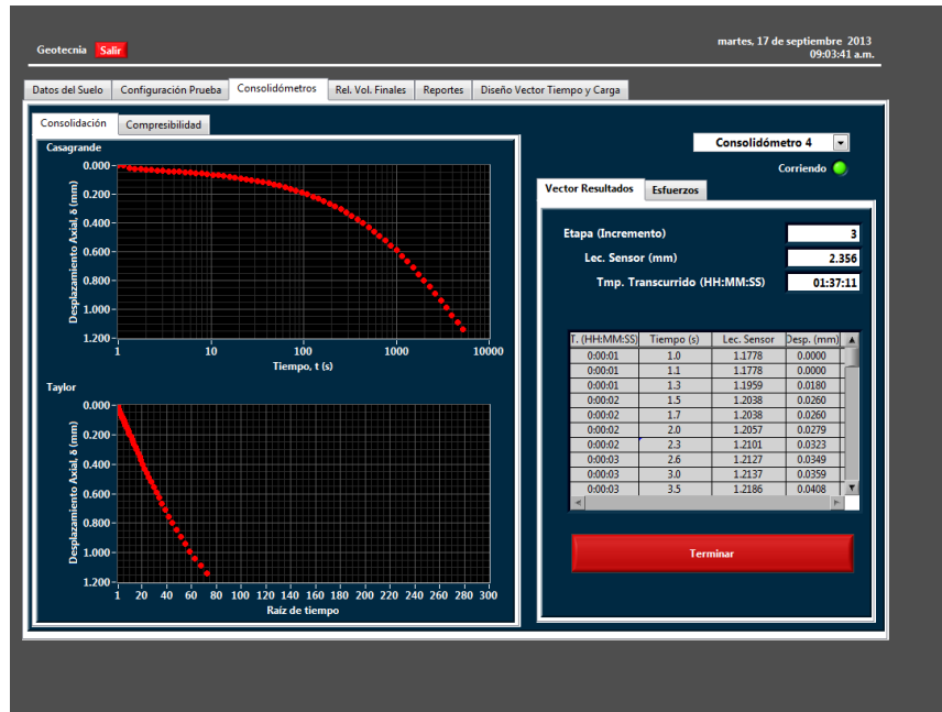
Figura 2.11 Adquisición de datos de consolidación.
