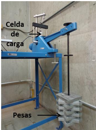
Figura 2. 25 Calibración de brazo de palanca de palanca.
