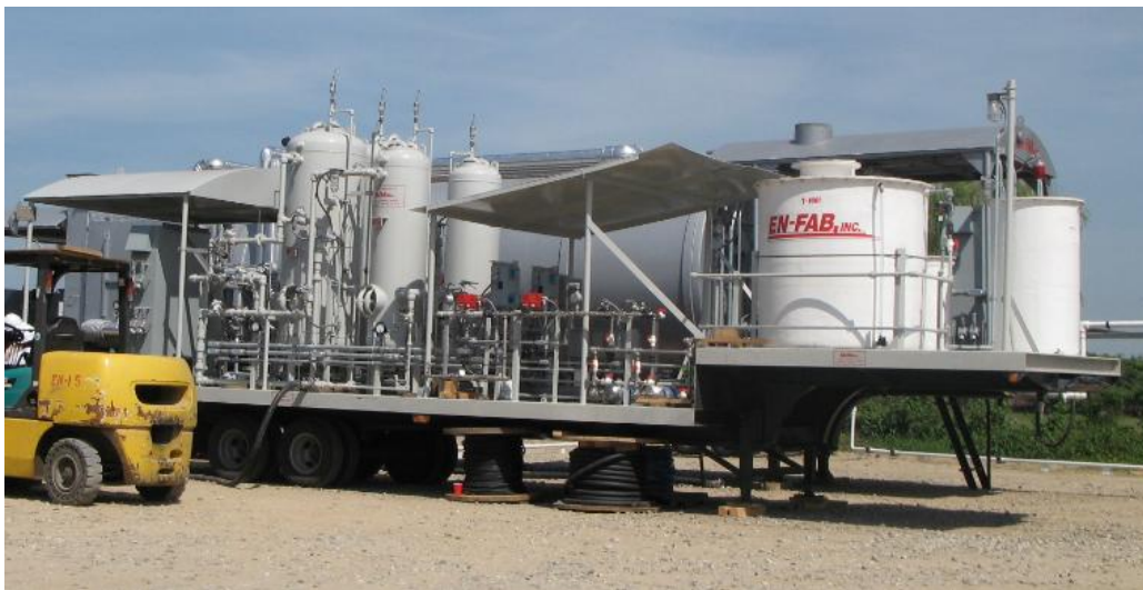
Fig. 30 Generador de vapor utilizado en campo Samaria.
