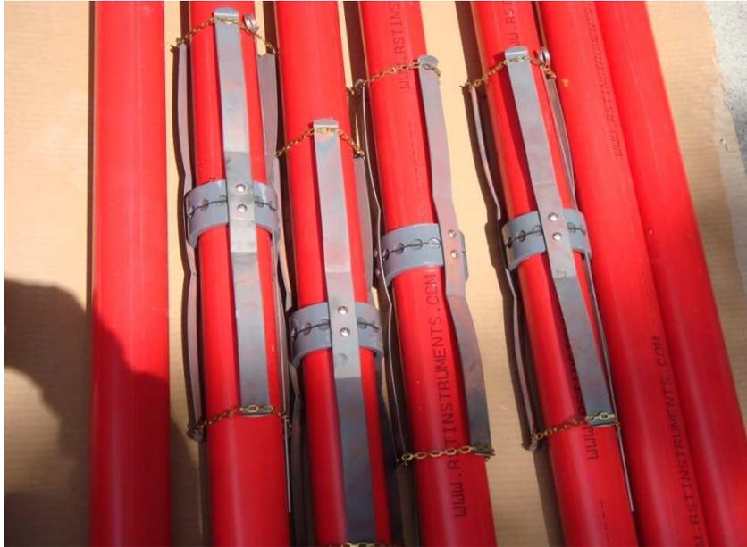
**Fig. 9 Arañas magnéticas en tubería para inclinómetro.**
