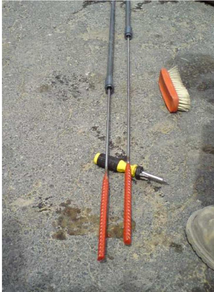
**Fig. 13 Extensómetro de barras.**
