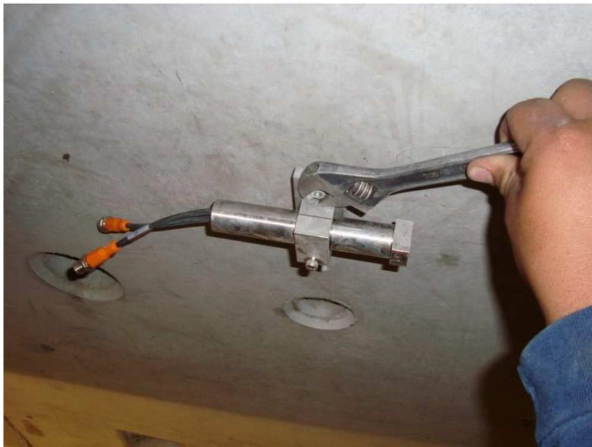
**Fig. 6 Tilt meter colocado en dovela.**
