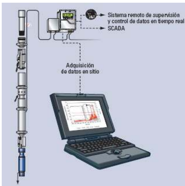
Figura 2.21 Sistema de supervisión y adquisición de datos 21 .
