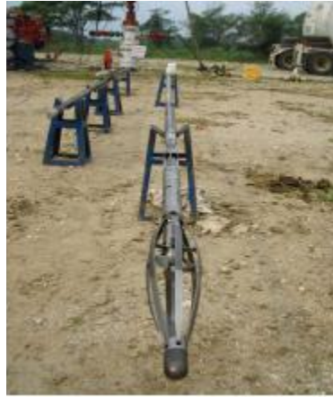
Fig. 3.12 Medidor de caudal total, el cual tiene una helice que gira a la razon de la velocidad del fluido
