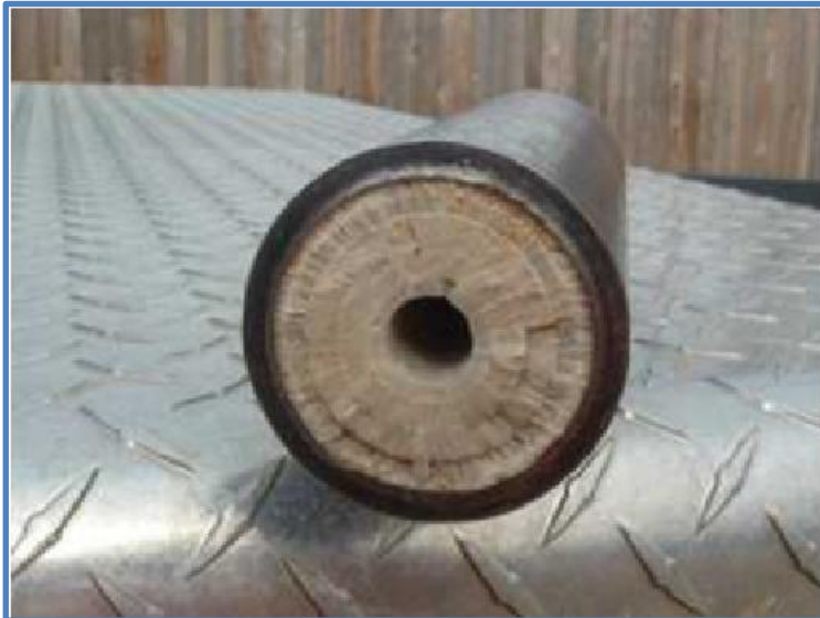
Figura 3- 13 Problemas con incrustaciones en líneas de flujo.
