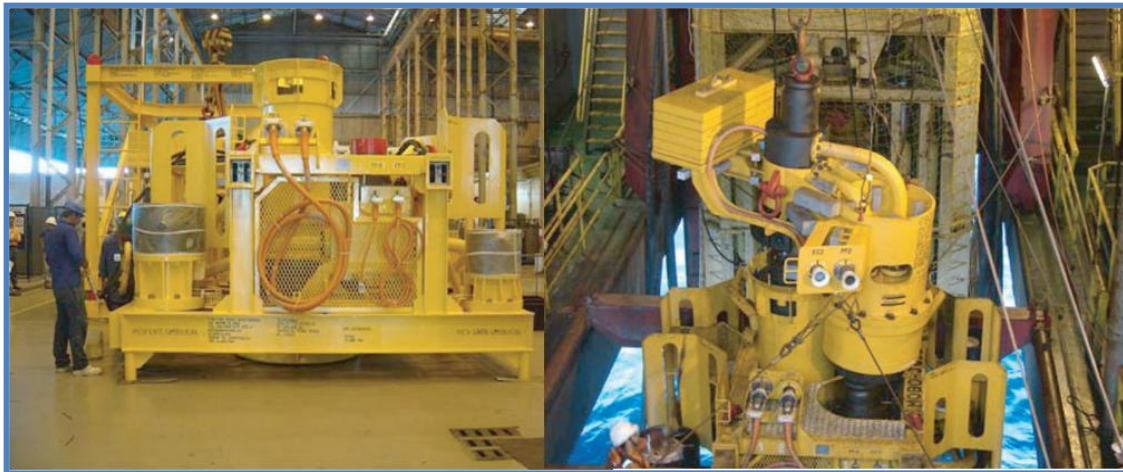
Figura 5- 23 Prototipo del adaptador de la base de la bomba (izquierdo) y la instalación del modulo de la bomba (derecha).
