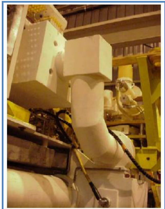
Figura 4-3 Aislamiento de un árbol submarino de producción.
