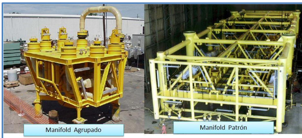
Figura 2- 24 Tipos de manifolds.
