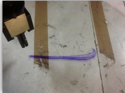
Imagen 3.1.4(a) Resultados adicionales de la utilización de las ecuaciones 3.1.3 y 3.1.4. (Izquierda) Imagen de una línea horizontal. (Derecha) Resultados del lugar geométrico de la trayectoria realizada por el robot Scora-ER 14Pro.
