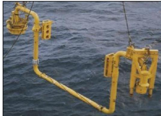
Fig. II.33 Jumper rígido
