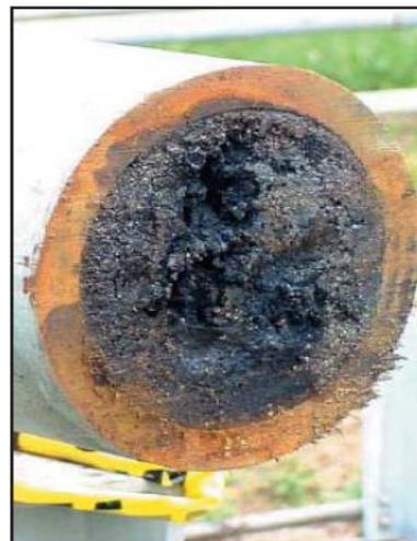
Fig. II.2 Sección de tubería taponada por deposición de asfaltenos
