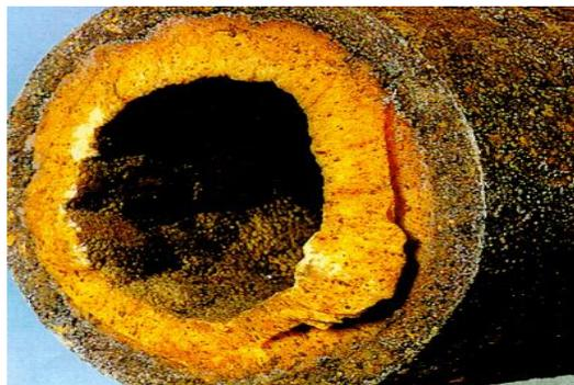
**Fig. II.3 Sección de tubería taponada por depositación de parafinas**
