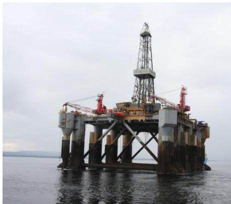
**Fig. II.14 Semisumergible DSS38 (estabilizada por columnas)**
