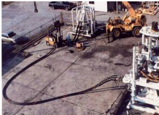
Fig. II.34 Jumper flexible
