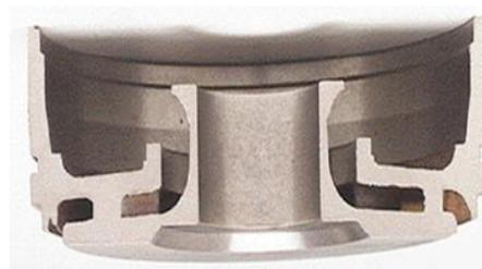
Fig. III.2 Difusor de una bomba BEC: estator
