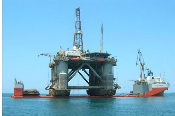
**Fig. II.12 Transporte de semisumergible en barcaza**
