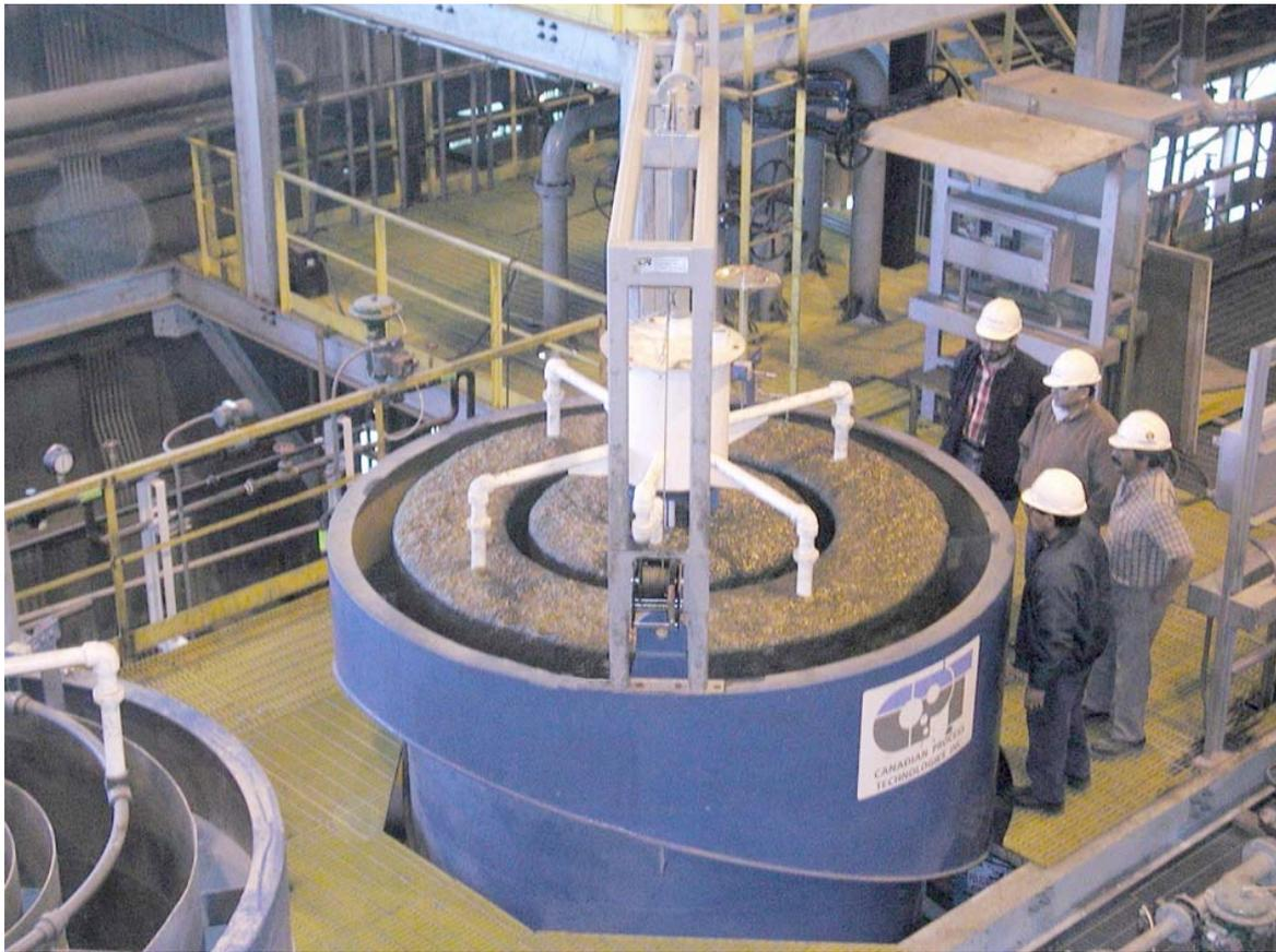
**Figura 3.23. Adición de agua de lavado para mejorar la calidad del concentrado (Tomada de boletín Cavitation Sparging System de Canadian Process Technologies Inc.)**
