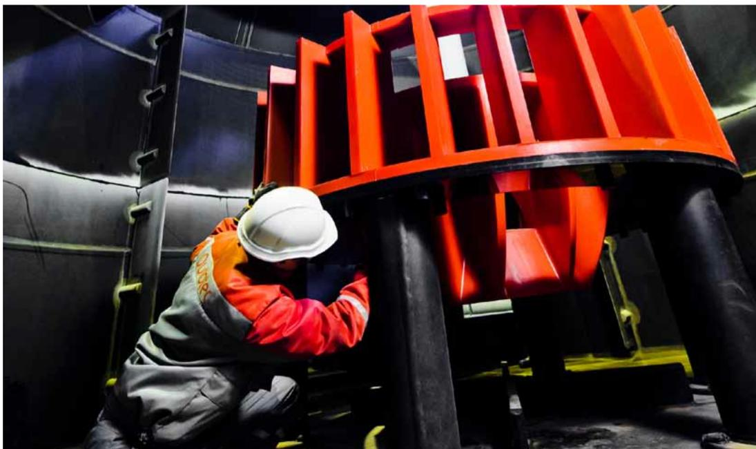
**Figura 3.14. Mecanismo de flotación FloatForce (Tomada de boletín Outotec FloatForce de Outotec)**
