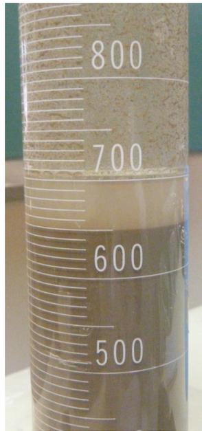
**Figura 4.2. Prueba de asentamiento de laboratorio**
