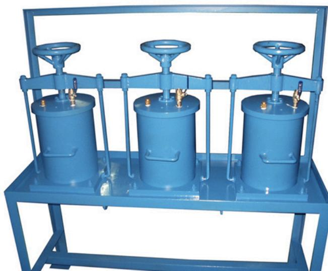
Figura 4.25. Filtros de laboratorio (Tomada de <http://www.vyma.com/es/laboratorios-mineros>)
