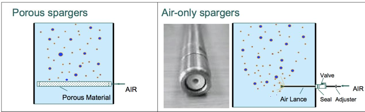
**Figura 3.16. Mecanismos de difusión de aire (Tomada de presentación Optimizing the Process with Metso CISA de Metso)**
