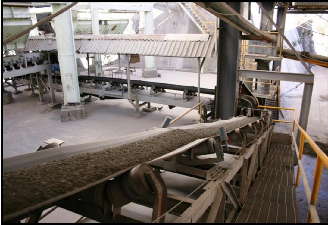
Foto 17.- Bandas AA-01 y AB-02 de la descarga de los silos, bandas TB-06 y TB-07 que alimentan a Molino de bolas.
