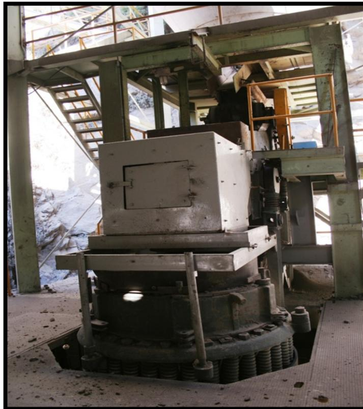
Foto 12.- Alimentador de Orugas, criba vibratoria y quebradora de cono symons de 4'.
