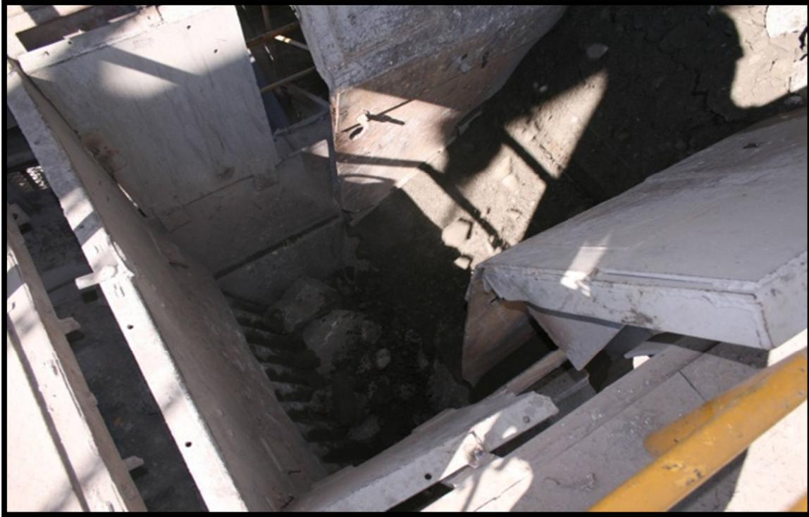
Foto 9.- Alimentador de oruga y quebradora de quijada para trituración primaria telsmith de 25" x 40".
