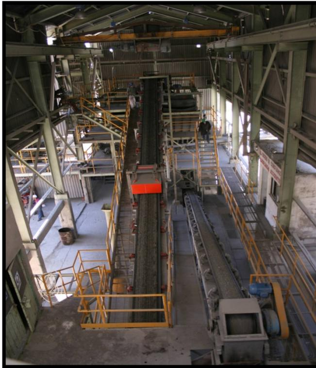
Foto 13.- Banda TB-01 que alimenta a dos cribas vibratorias Alis Chambers de 6'x12' (IZQUIERDA) y banda TB-02 en circuito cerrado (DERECHA).
