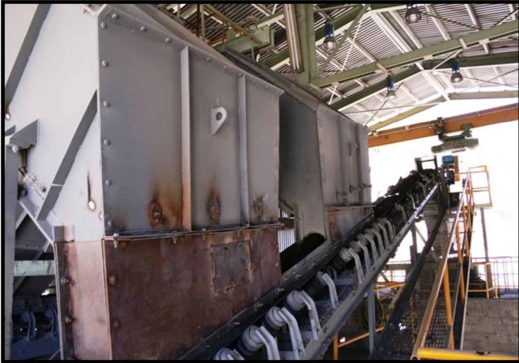
Foto 15.- Vista de banda TB-05 que alimenta los finos de las cribas vibratorias a los silos de finos.
