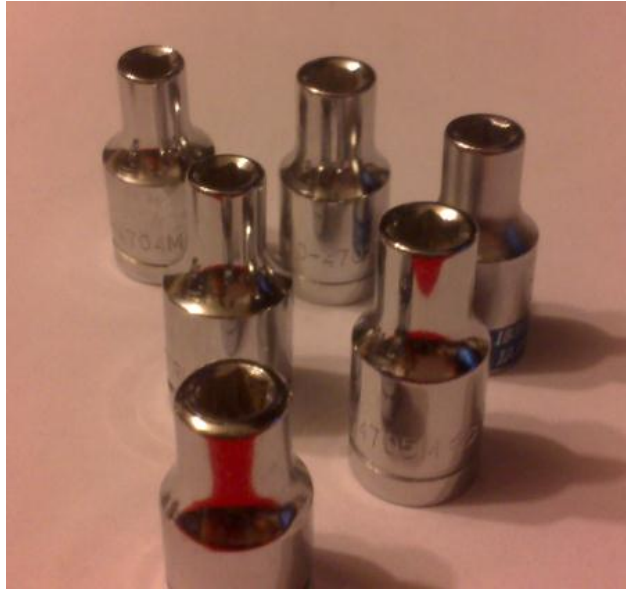
Figura 3.6. Dados seleccionados para sujetar las probetas durante el ensayo de torsión
