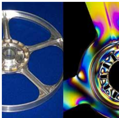
Figura 1.3. Visualización del campo de esfuerzos en un cuerpo por medio de la técnica de fotoelasticidad
