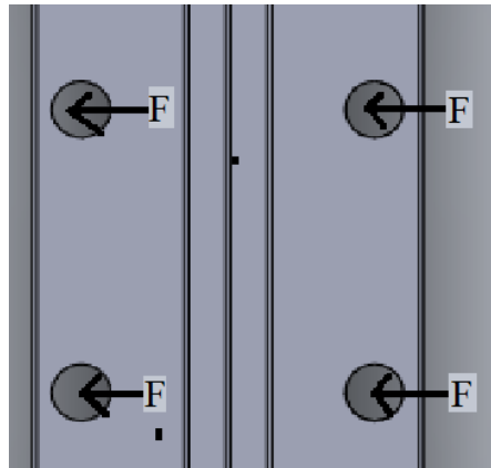
Figura 3.10. Visualización de la fuerza que transmite cada tornillo al perfil de aluminio
