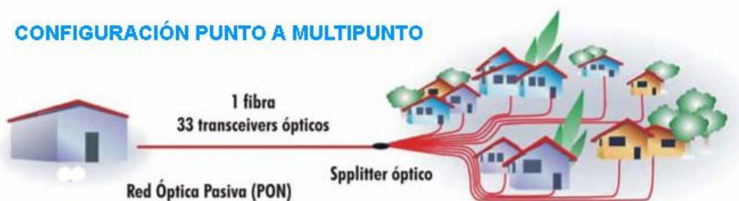
Figura 4. Configuración punto a multipunto.
