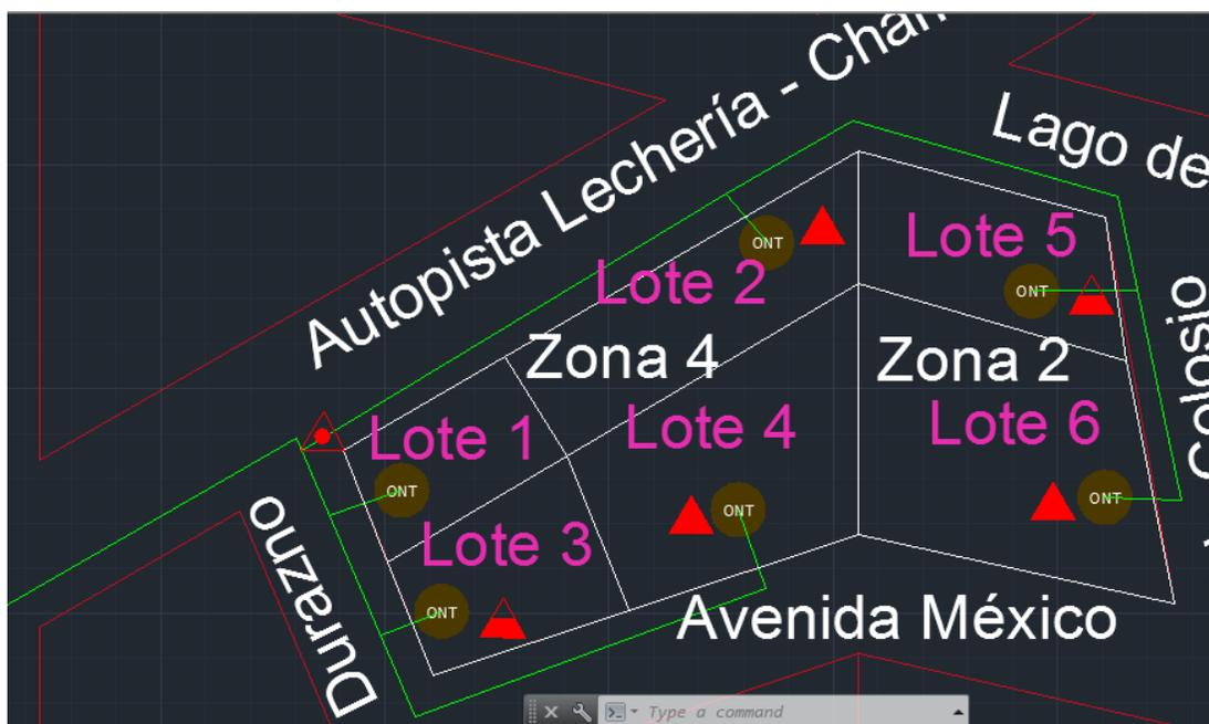
Figura 87. Plano con los elementos ONT insertados.
