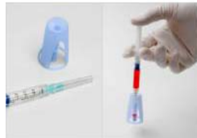
Figura 4.9 Imagen donde se muestra el dispositivo para la ventilación segura
