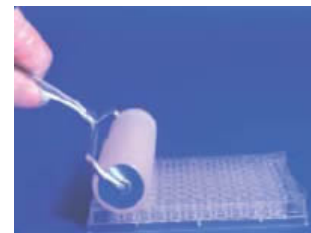
Figura 2.6. Imagen donde se muestra el rodillo empleado para sellar las microplacas.
