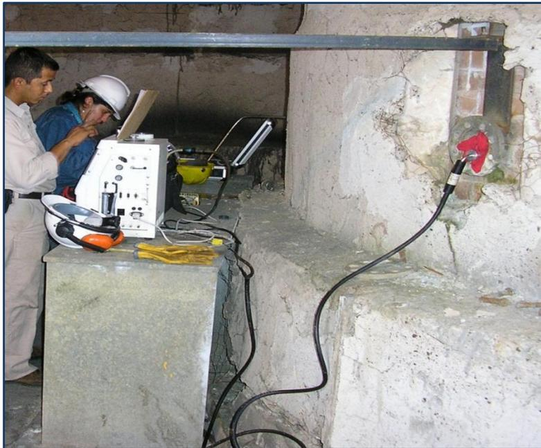
Figura 3.4. Muestreo de gases en la Central Termoelectrica.
