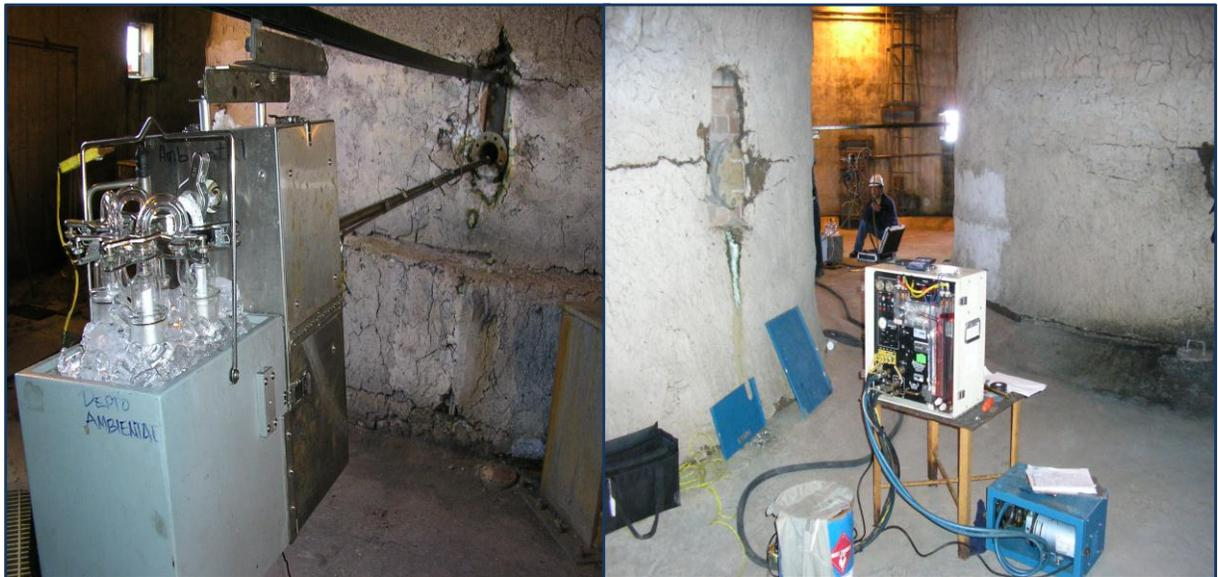
**Figura 3.2. Muestreo de partículas en la Central Termoelectrica**
