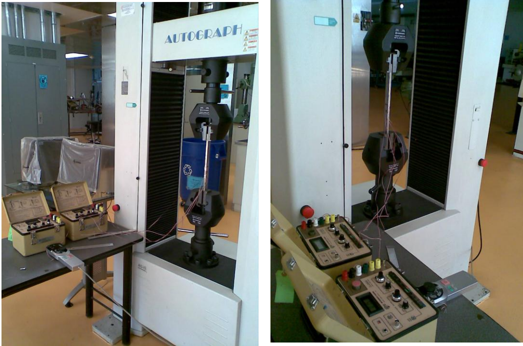
Fotografías 5 y 6. Prueba de tensión simple, material compuesto laminado metálico A-L-A.
