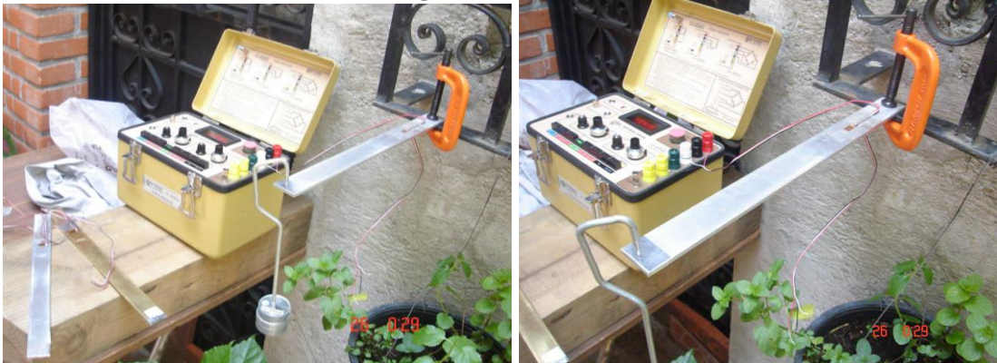
Fotografías 3 y 4. Obtención de las propiedades mecánicas de aluminio y latón.
