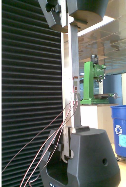
Fotografía 7. Prueba de tensión simple, material compuesto laminado metálico A-L-A, acercamiento.
