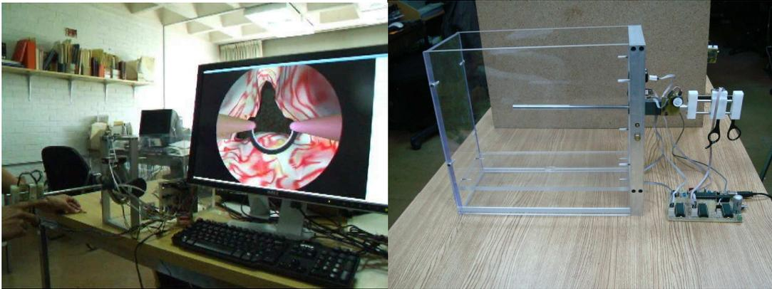
**Figura 2.12** *Simulador de Realidad Virtual de RTUP completo del Grupo de Análisis de Imágenes y Visualización del CCADET. El bloque de gráficos consiste en el despliegue de la escena 3D con OpenGL en un monitor estándar de computadora.*
