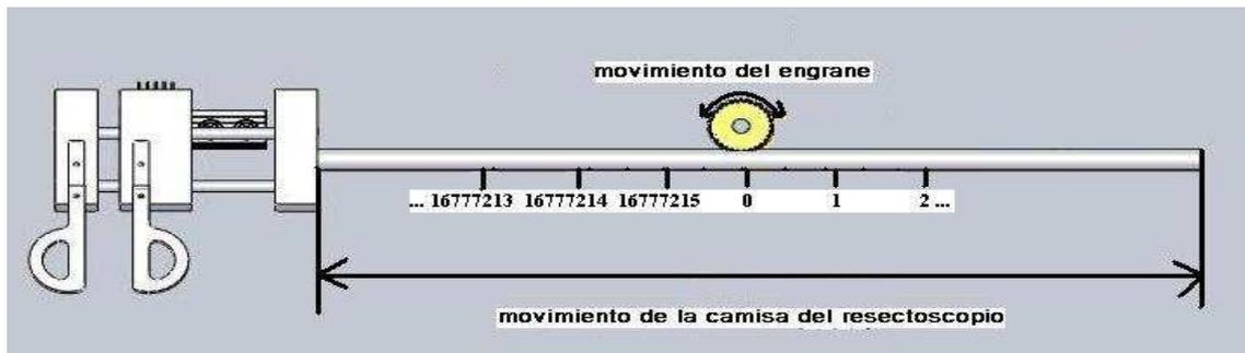
**Figura 3.17** Lectura de contador de pulsos LS7266R1 de los pulsos generados por el codificador óptico
