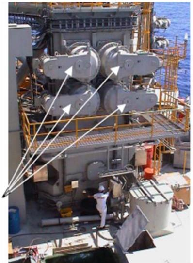
Motores del Sistema de Elevación
