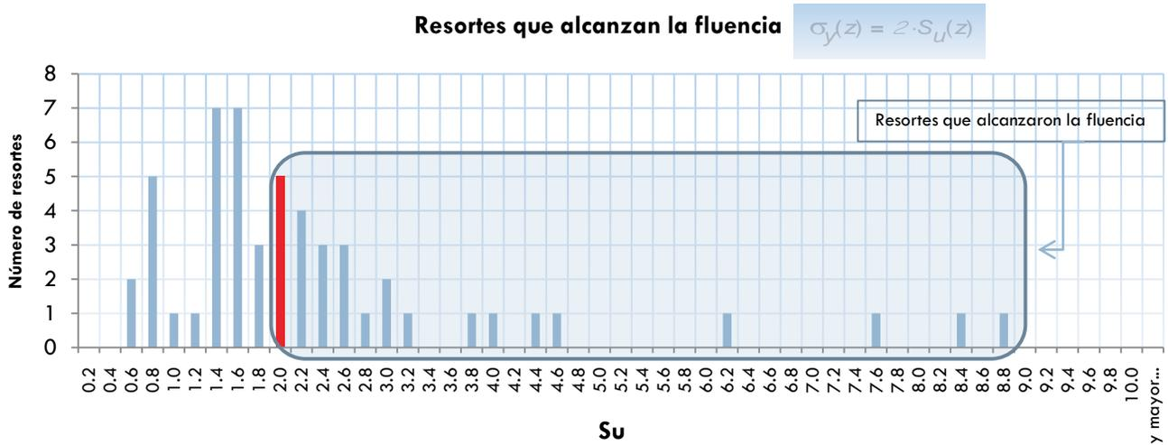
FIGURA IV-6 HISTOGRAMA CON LA DISTRIBUCION DE DE LOS RESORTES QUE ALCANZAN LA FLUENCIA
