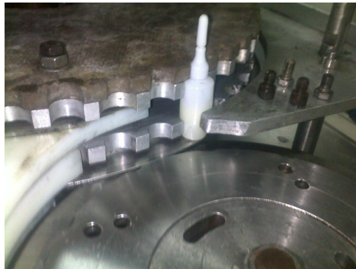
Fig. 6.4 Disco transportador de ampollitas. Fotografías tomadas en la Planta de producción en su actual instalación.
