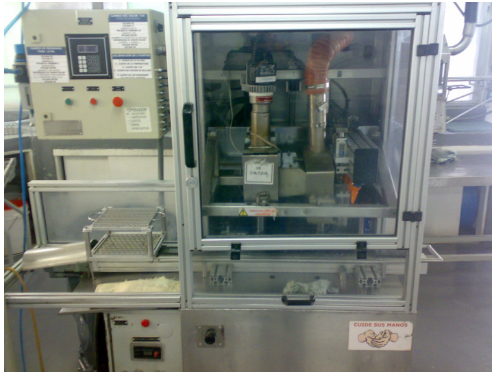
Figura 1.2 Segunda generación de máquina selladora de ampolletas. Máquinas diseñadas en el CDMIT. Fotografías tomadas en la Planta de producción en su actual instalación.
