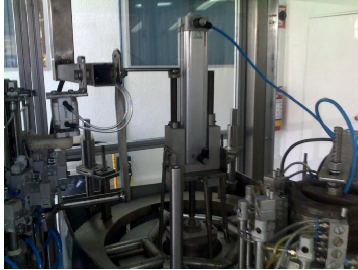
Fig. 6.2 Pistón de elevación en la zona de calentamiento. Fotografías tomadas en la Planta de producción en su actual instalación.
