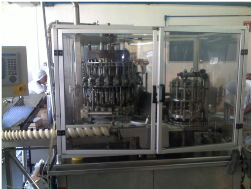
Figura 1.3 Tercera generación de máquina llenadora y selladora. Máquinas diseñadas en el CDMIT. Fotografías tomadas en la Planta de producción en su actual instalación.
