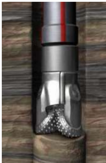
Figura 2.15. Rebote de barrena.
