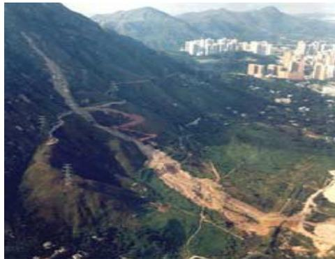
Figura 6.8 Imagen de una falla por deslizamiento superficial en una ladera natural.
