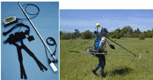
**Figura 3.11** Equipo empleado para el método magnético (magnetómetro).
