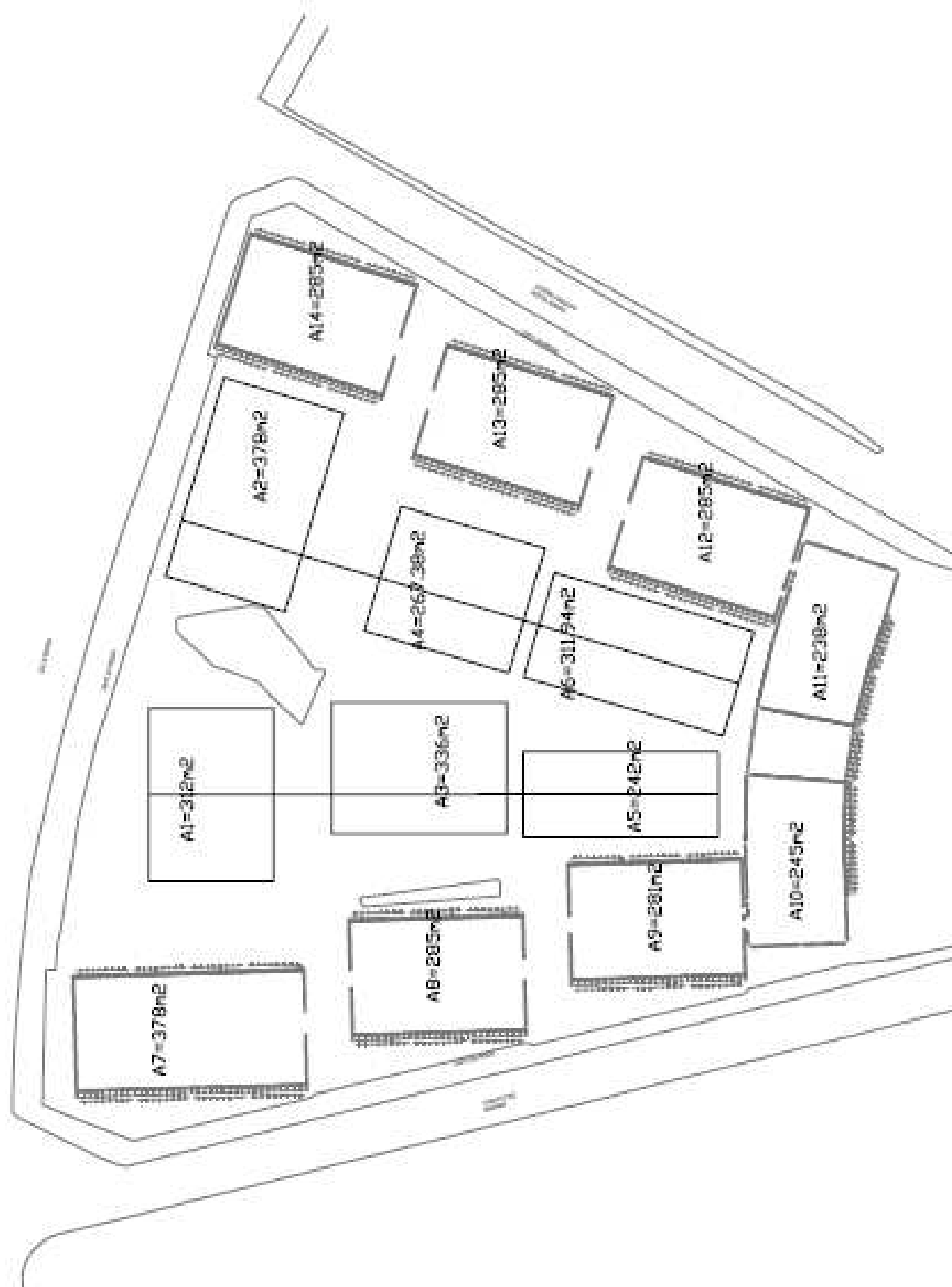
Figura anexa 2. Vista en planta de distribución de los dispositivos sobre el terreno
