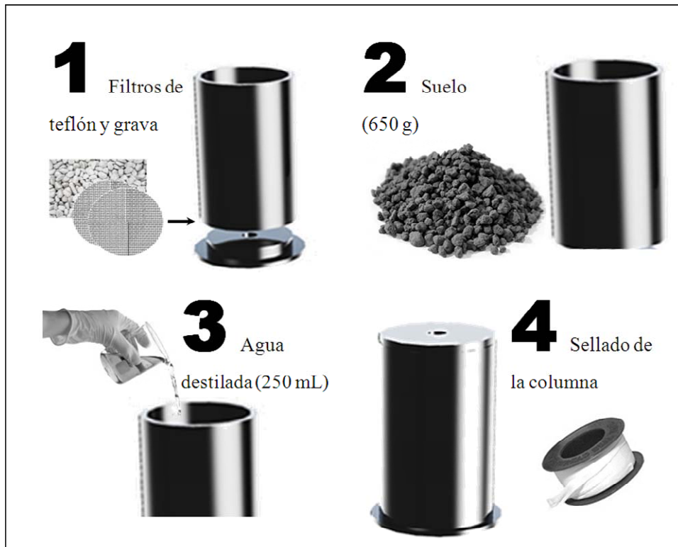
Figura 4-2 Empaque de las columnas
